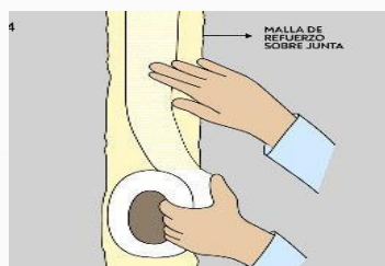
Paso No.5 Coloque la malla de refuerzo mientras la primera capa de DECOFLEX esta húmeda y déjela secar por al menos dos horas.
